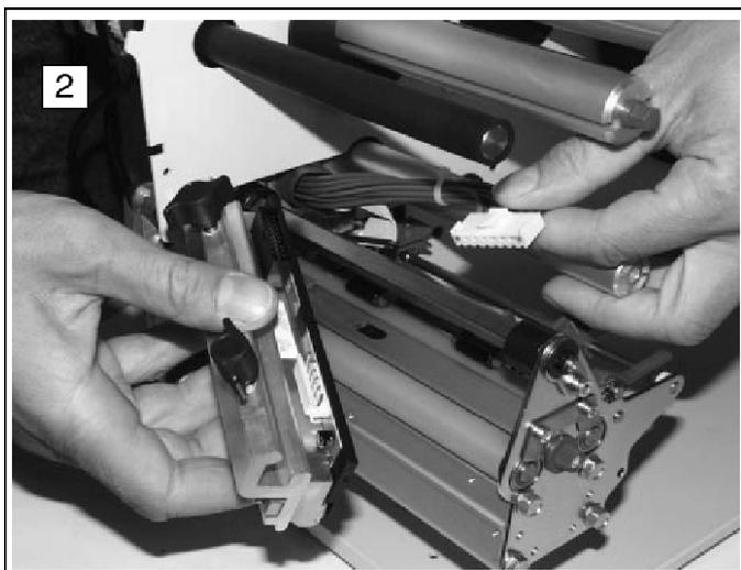
Abb. 7.2.1.b Druckkopf entnehmen
