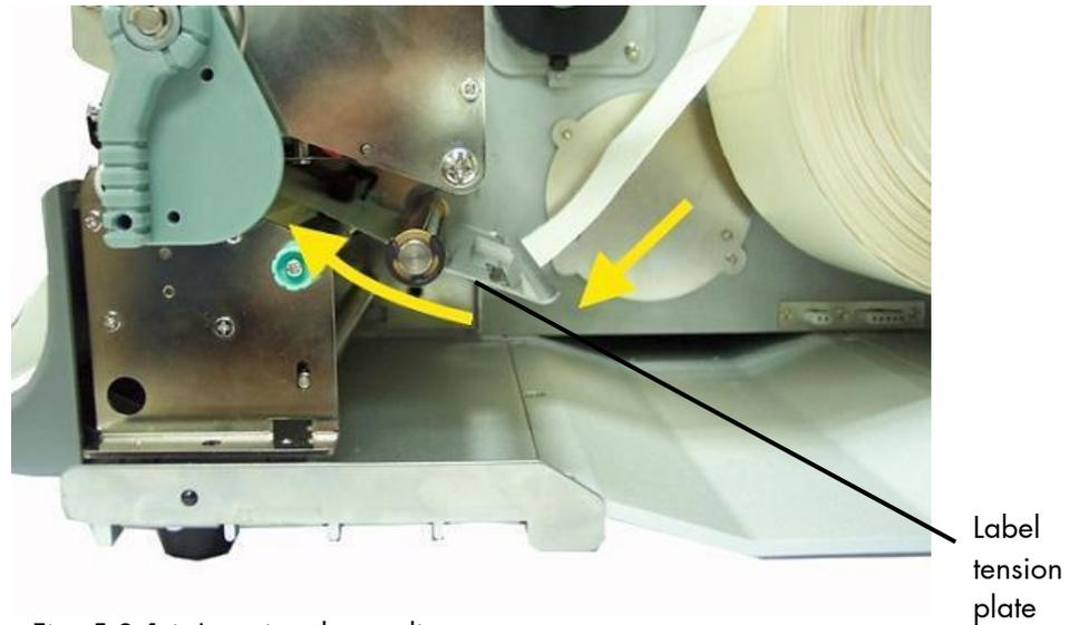
Fig. 5.2.1.i Inserting the media
