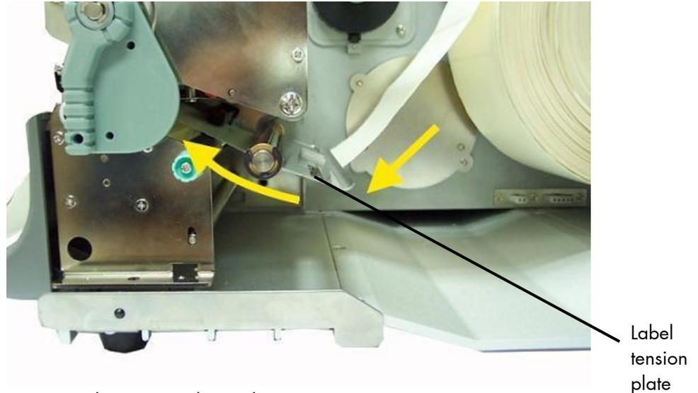
Fig. 9.3.1.b Inserting the media
